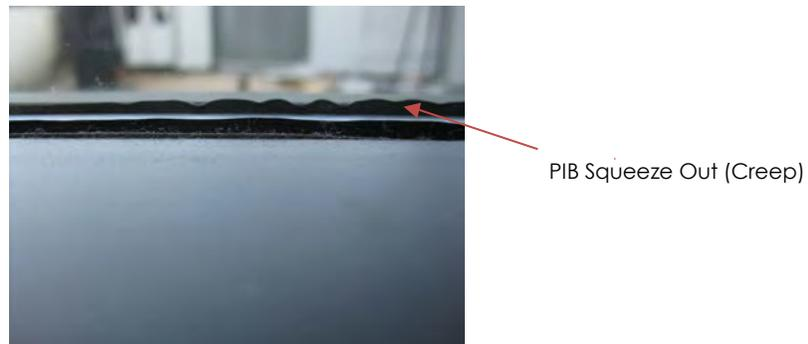
Figure 1.8.1, PIB Squeeze Out (Creep)
